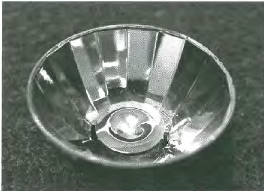
Figura 2.47 Ottica secondaria a riflettore, in polimero trattato con ossido di alluminio. Nella zona centrale un piccolo schermo riflettente copre la capsula del LED, in funzione antiabbagliamento (documentazione e produzione FRAEN).
